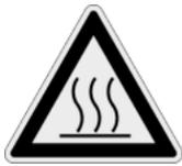
Las superficies metálicas del interior se calientan durante la operación. Estas piezas **SOLO** pueden tocarse con un equipo de protección adecuado. Utilice un equipo de protección adecuado contra quemaduras y escaldaduras.
