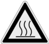
Les surfaces métalliques à l'intérieur deviennent chaudes pendant le service. Ces pièces **NE** doivent être touchées **QU'**avec un équipement de protection approprié. Portez un équipement de protection approprié contre les brûlures et les échaudures.
